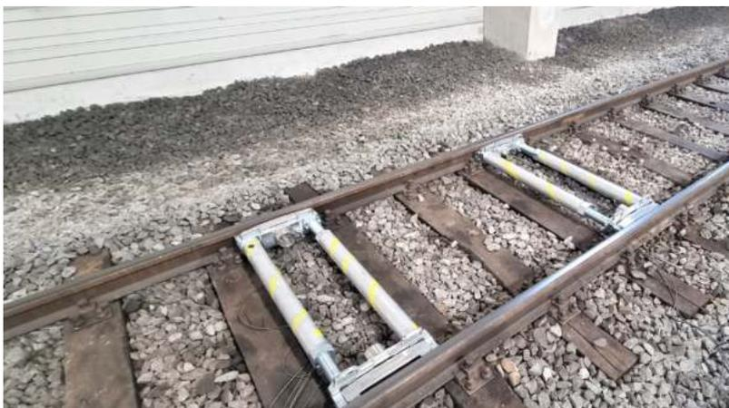
*Gleiswaage mit PJM-Know-how zur Kalibrierung des Ladesystems.*
