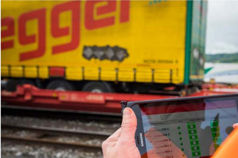
*Der neue Alltag bei der SBB Cargo: Anstelle der ergonomisch ungünstigen und anstrengenden manuellen Kontrolle der Bremsen, werden alle Ergebnisse der automatisierten Bremsprobe auf dem Tablet dargestellt.*
