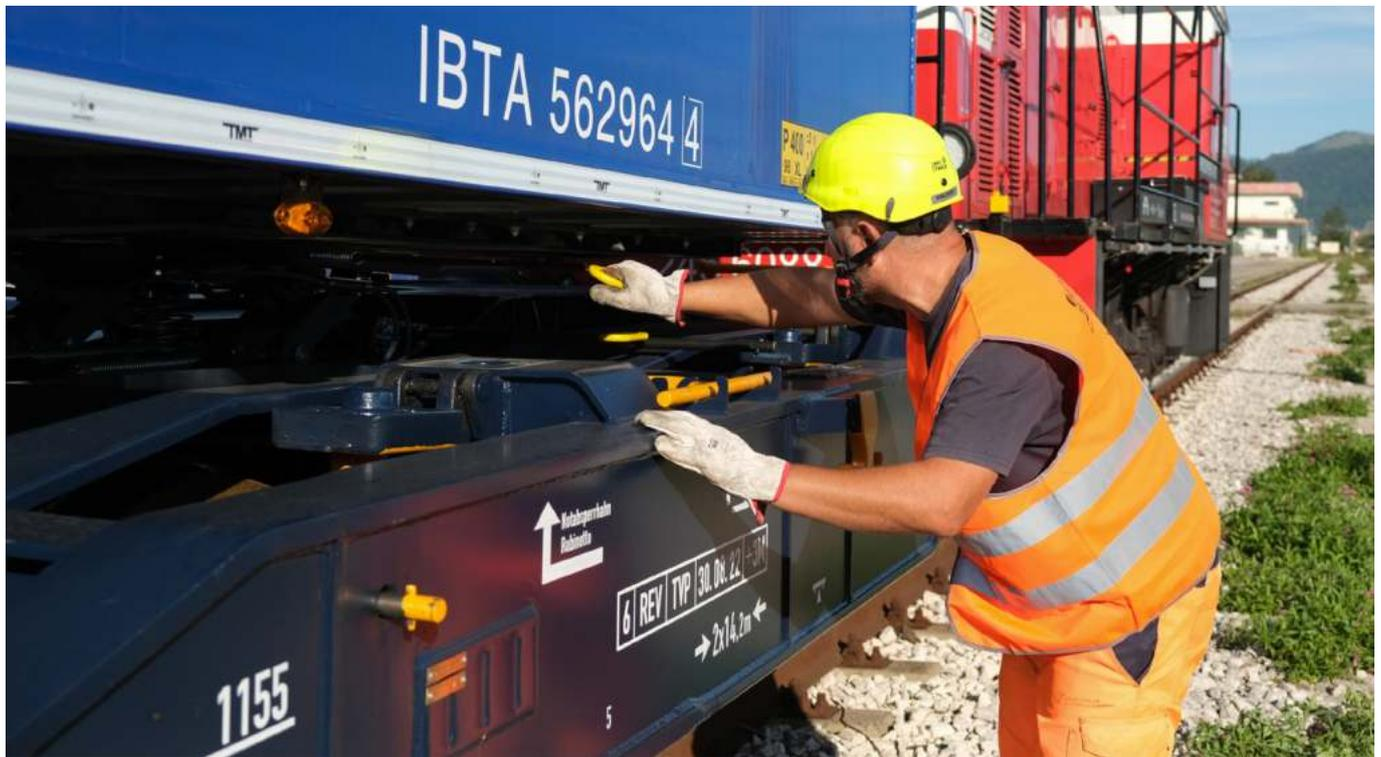
Die Stützbock-Überwachung in Echtzeit ermöglicht eine zuverlässige Erkennung der korrekten Einstellung und Verriegelung während des Anhängertransports im intermodalen Bereich. Bildnachweis: Polo Logistica FS, honorarfrei
